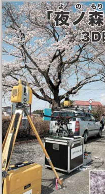
↑車載式の3Dレーザースキャナやドローンで桜並木をデータ化 →
